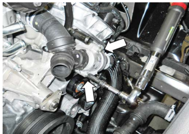
5. Установите два (2) болта крепления корпуса термостата и затяните их с моментом 10 Нм.
