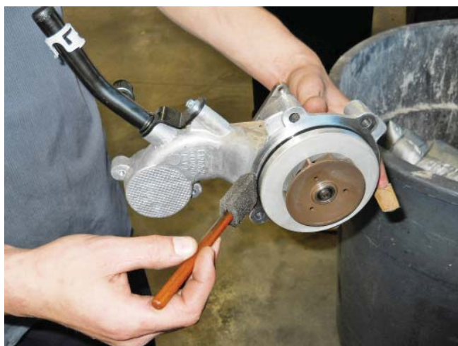
3. Установите водяной насос на переднюю крышку и установите только три (3) болта. Оставьте болт в положении 10 часов. Затяните болты с моментом 25 Нм.
