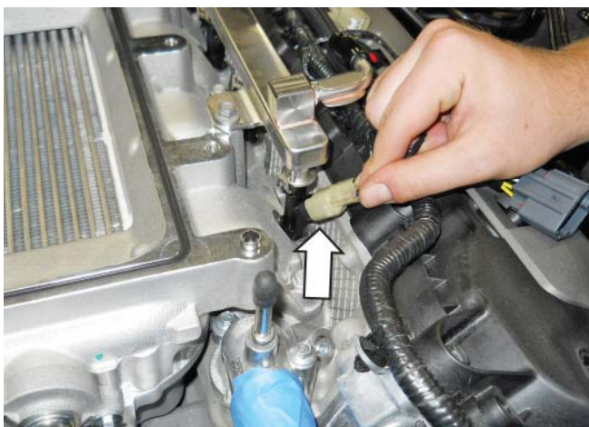
9. Осторожно поместите сборку нагнетателя (1315-6F066) на верх впускного коллектора. Убедитесь, что нагнетатель полностью установлен на опорные штифты впускного коллектора. Удалите защитные покрытия доставки.
