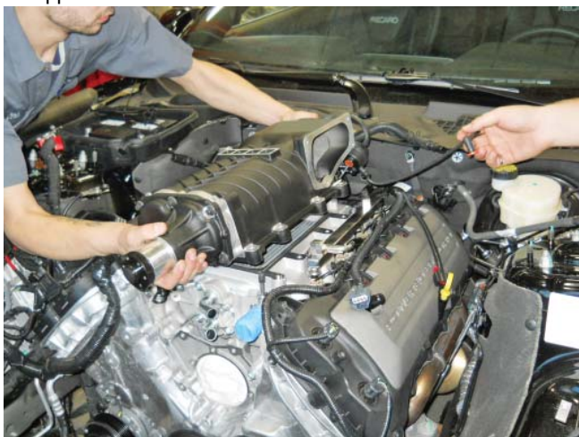
9. Осторожно поместите сборку нагнетателя (1315-6F066) на верх впускного коллектора. Убедитесь, что нагнетатель полностью установлен на опорные штифты впускного коллектора. Удалите защитные покрытия доставки.
