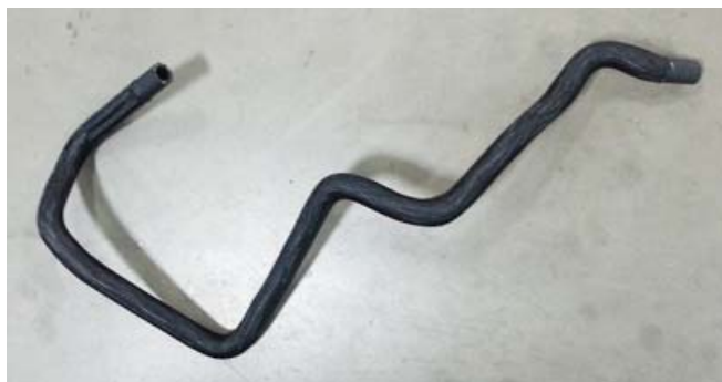
шланг отвода (выходного) низкотемпературного радиатора (LTR) (1315-8D030)
