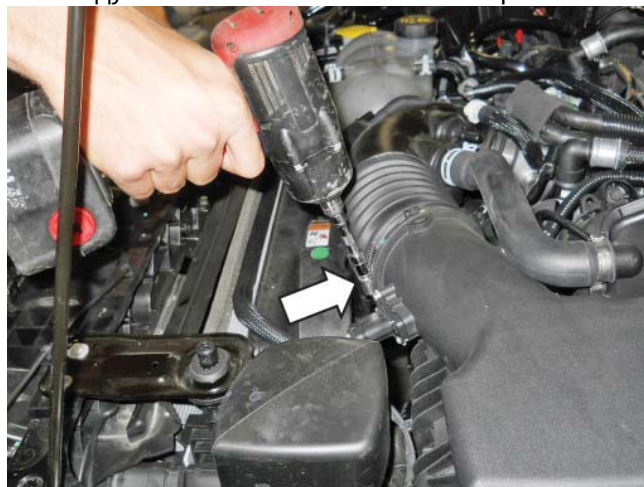
Хомут на коробке воздушного фильтра
