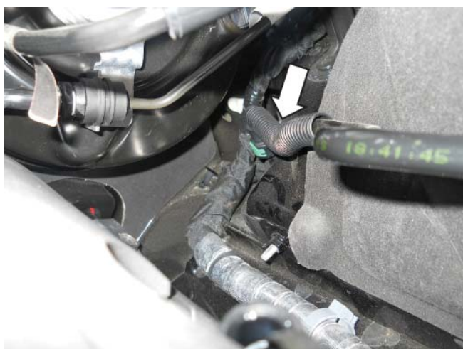
Отсоедините зеленое быстросъемное соединение
