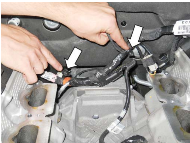
Заклепки на проводке
