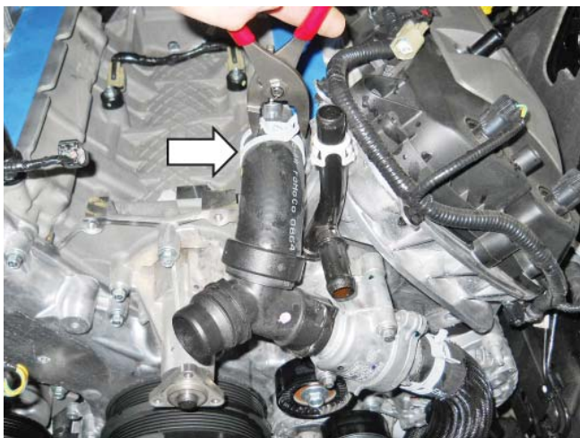
55. Снимите два (2) болта с термостатного корпуса (головка 8 мм).
