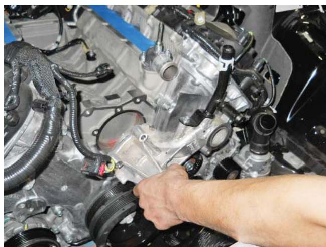
58. Положите чистое полотенце в полость впуска насоса водяного насоса.
