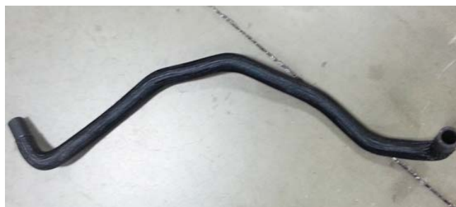
Входной шланг насоса интеркулера (1315-8D029)
