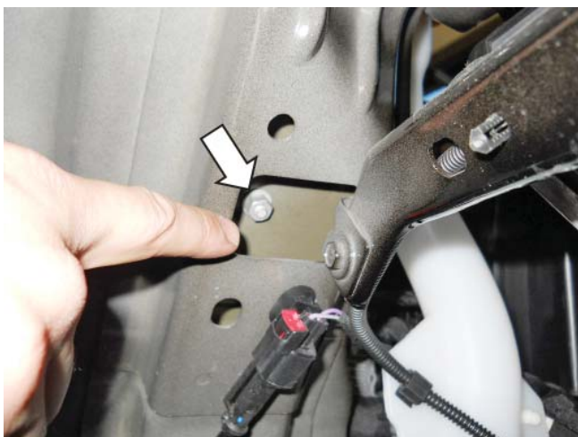
Гайка крепления реле, вид с внутренней стороны отверстия колесного арки
