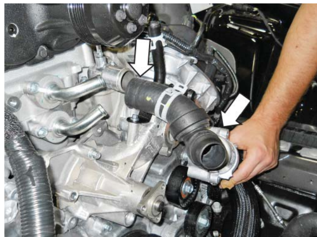
5. Установите два (2) болта крепления корпуса термостата и затяните их с моментом 10 Нм.
