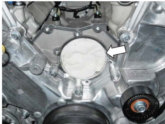
58. Положите чистое полотенце в полость впуска насоса водяного насоса.
