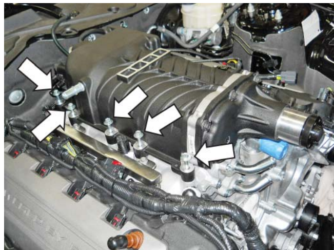
10. Установите десять (10) крепежных винтов M8 x 1.25 x 53 (N808130) из комплекта крепежных изделий В (1315-TVSHKB) в отверстия для монтажа. Затяните винты моментом 25 Нм в указанной последовательности (головка 10 мм).
