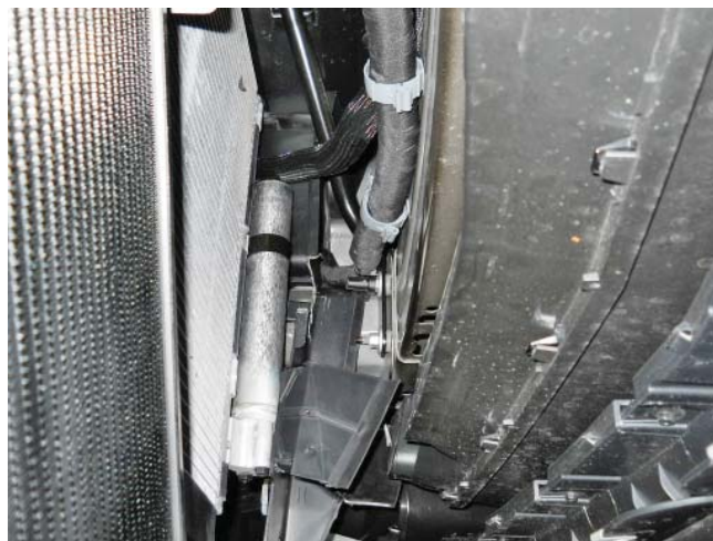
шланг отвода (выходного) низкотемпературного радиатора (LTR) (1315-8D030)
