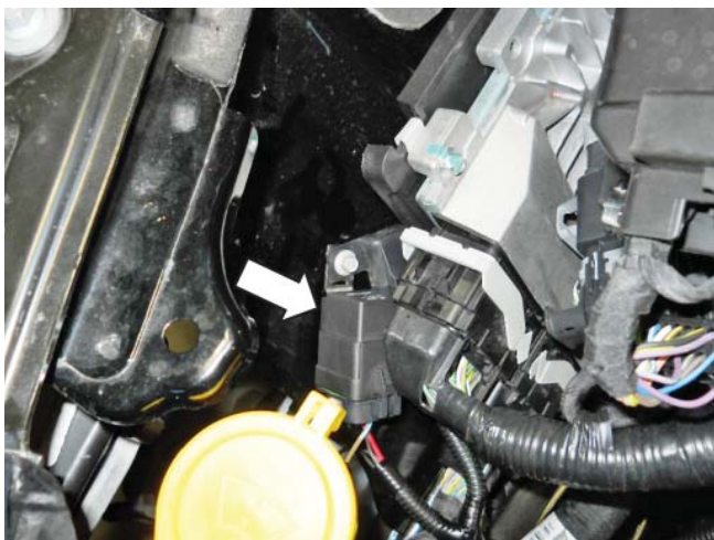
Болт реле, передняя сторона
