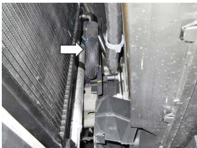
шланг отвода (выходного) низкотемпературного радиатора (LTR) (1315-8D030)
