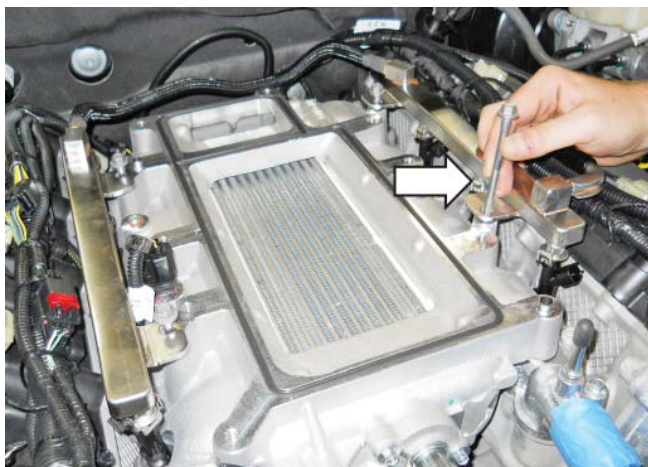
8. Подключите восемь (8) электрических разъемов топливных форсунок.
