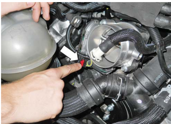
25. Отсоедините электрический разъем дроссельной заслонки. Потяните красную защелку назад и нажмите черную защелку, чтобы разблокировать соединение.
