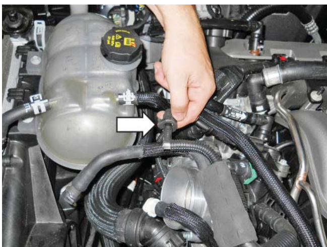
25. Отсоедините электрический разъем дроссельной заслонки. Потяните красную защелку назад и нажмите черную защелку, чтобы разблокировать соединение.
