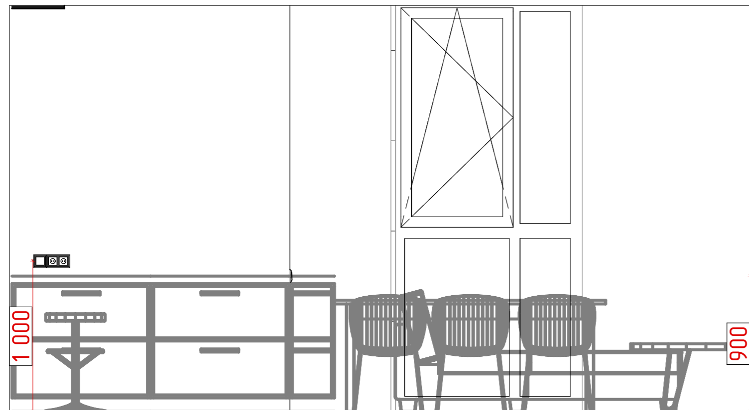
Кухня привязка электрооборудования
