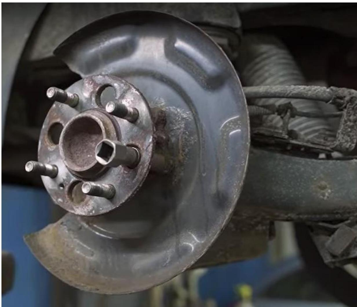
Крепление ступицы к рычагу осуществляется при помощи 4-ёх болтов, которые нужно открутить головкой. Далее саму ступицу можно демонтировать. Обычно она прикипает к корпусу, и её необходимо аккуратно обстукивать молотком при демонтаже. Можно в месте посадки детали нанести спрей-смазку и подождать 10 минут.
