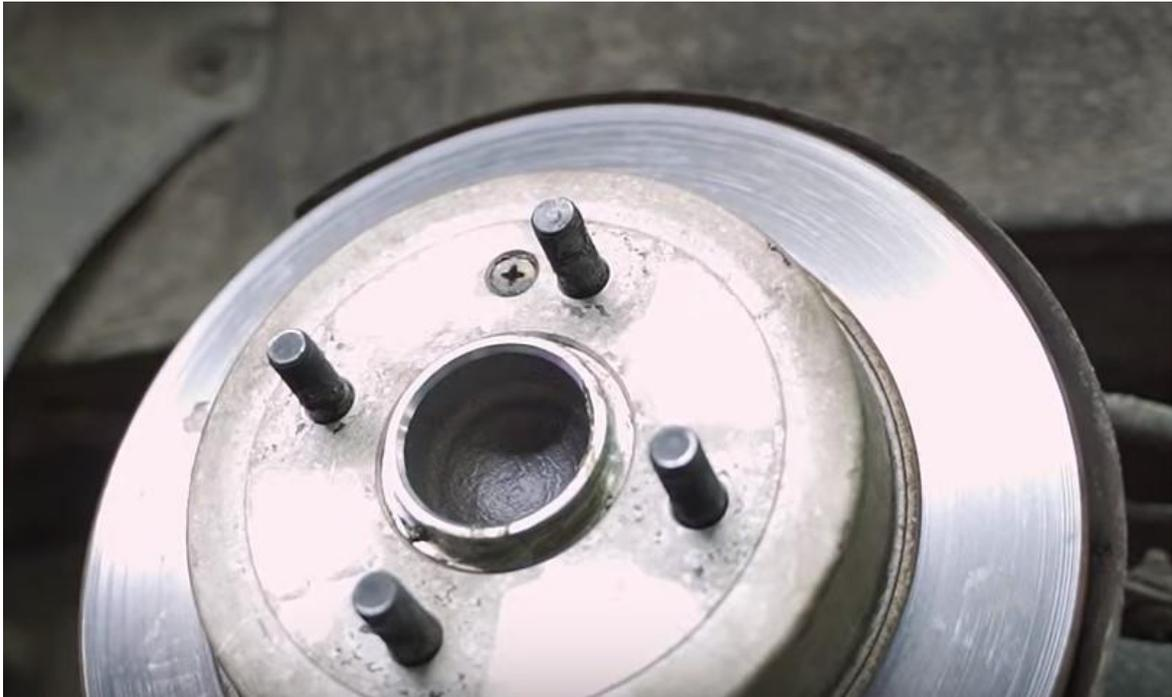
На следующем этапе открутить центрирующий болт. Обычно он плохо откручивается, и для этого можно использовать ударную отвёртку, нанеся по центру болта несколько ударов. Далее диск или барабан нужно демонтировать со ступицы, аккуратно постукивая по месту посадки, если он прикипел к корпусу.
