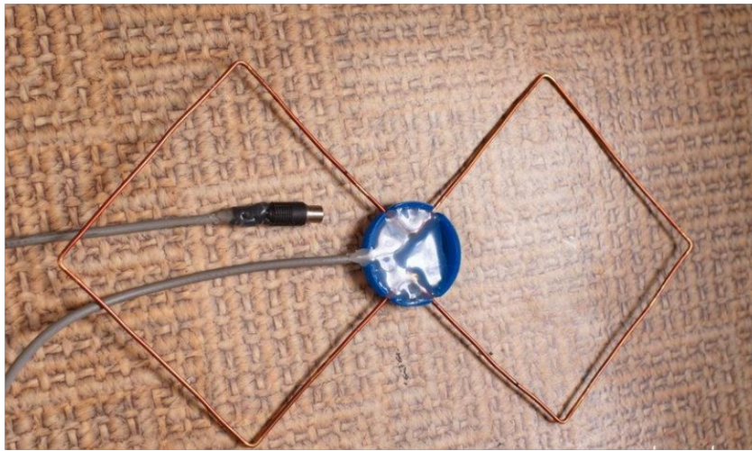
antenna_eight_3.jpg Кабельный штекер перед герметизацией
